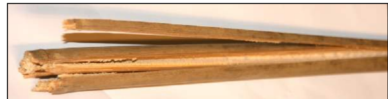
Der Bambus ist auf Schlagseite mehrfach gesplittert, keine schöne Sache ohne Durchstechschutz.
