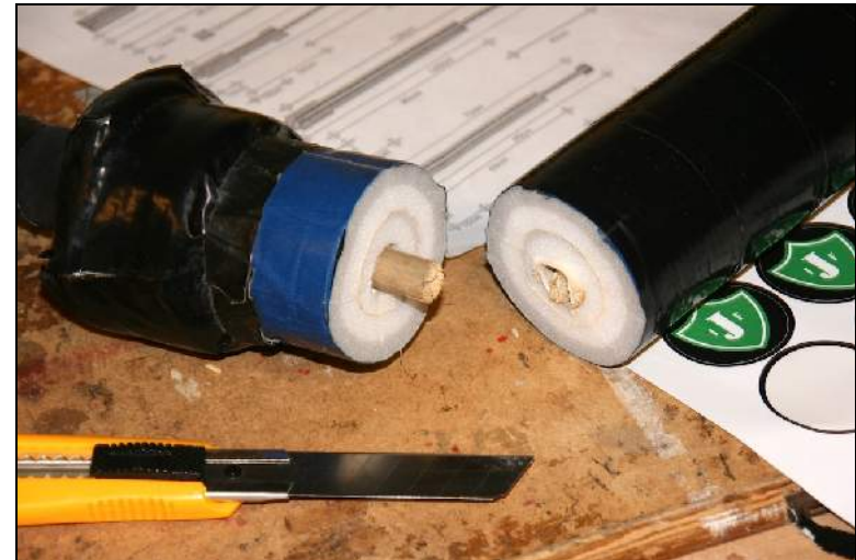
Das E-Rohr ist sauber rundum gebrochen, der Bambus blieb aber im Rohr. Die Polsterung war übrigens unversehrt.
